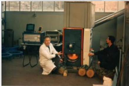
1987 – Turbogeneratore ORC a biomassa da 3 kW el , Milano
